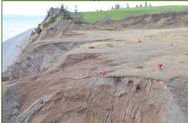
Source G.Bélanger, Nov.26.11. Carleton-sur-Mer, Qc: Mesuring distance between the stake and the cliff's ruptured edge./ Mesurage de la distance entre une borne et la rupture de pente sur une falaise de dépôts meubles.
