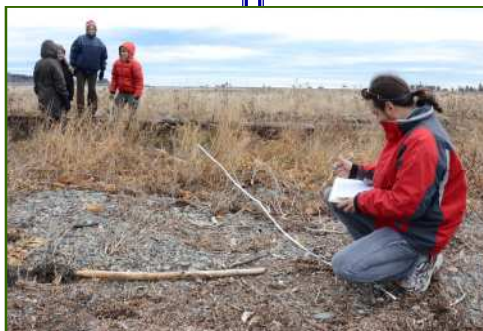
Source G. Bélanger, Nov.26.11. Carleton-sur-Mer, Qc : Mesure of distance between stake and vegetation line on the sand bar./ Mesurage de la distance entre une borne et la limite de la végétation sur une flèche de sable du barachois.
